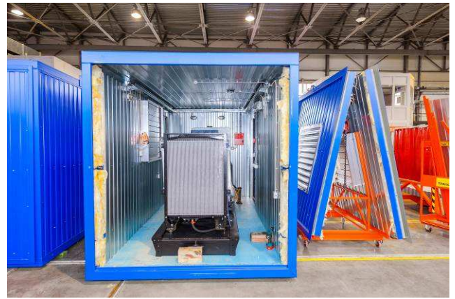
Быстроремонтная торцевая стена для удобства монтажа / демонтажа оборудования, ремонта ДЭС
