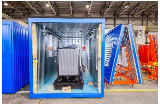
Быстроразъемная торцевая стена для удобства монтажа / демонтажа оборудования, ремонта ДЭС
