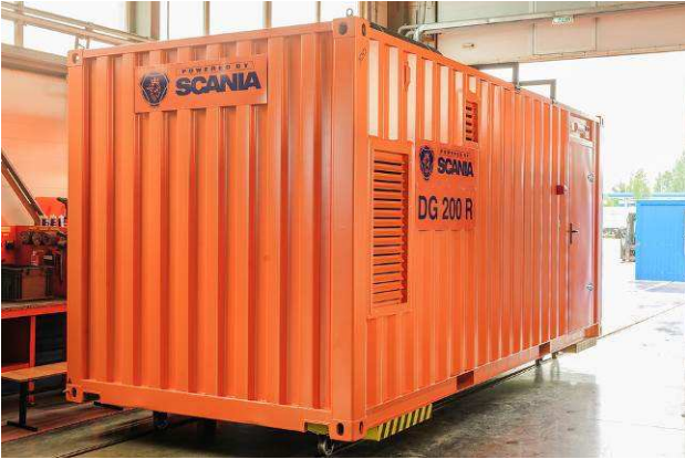
Снаружи несущий каркас обшивается профилированной оцинкованной листовой сталью со стойким ПВХ покрытием
