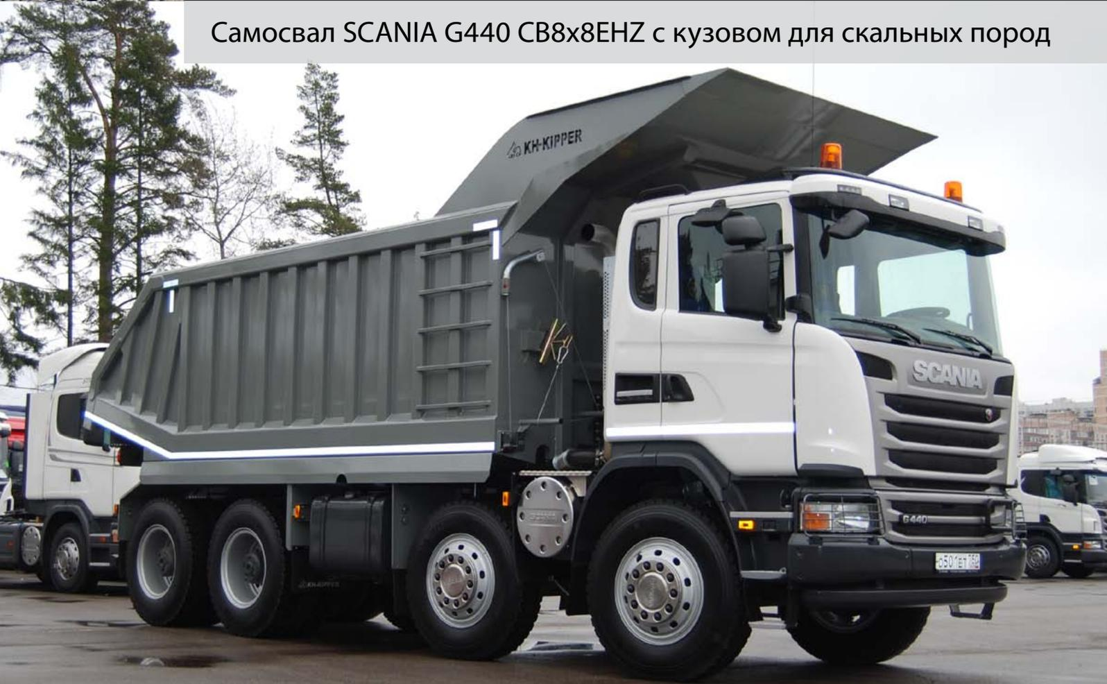
Высокопроизводительный полноприводный самосвал SCANIA G440 CB8x8EHZ имеет грузоподъемность 30 тонн и предназначен для транспортировки скальных, вскрышных пород и других материалов с плотностью до 1400 кг/м<sup>3</sup> в разрезах, карьерах и по дорогам общего пользования. Загрузка предпочтительна гидравлическими экскаваторами или фронтальными колёсными погрузчиками с объёмом ковша 2 – 5 м<sup>3</sup>.
