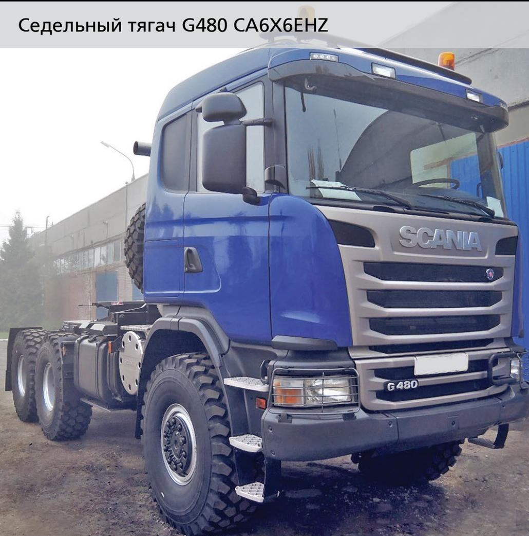
Полноприводный седельный тягач SCANIA G480 CA6X6EHZ предназначен для транспортировки полуприцепов с грузами и материалами как на технологических площадках, так и на дорогах общего пользования. Поставляется на односкатной ошиновке с шинами 16.00R20, что обеспечивает оптимальное соотношение проходимости и грузоподъемности.
