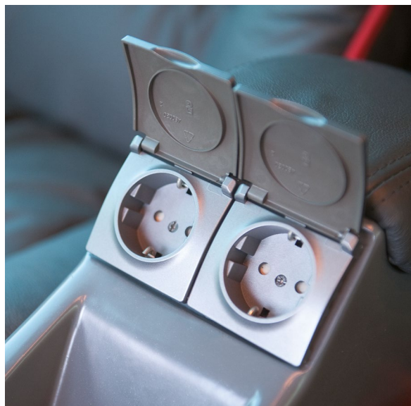
Розетки электропитания 220 В
